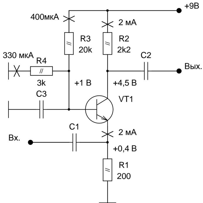
1. Напряжение на коллекторе обычного усилительного каскада берут  $U_{п./2}$ . У нас будет 4,5 В. Падение на R2 тоже будет 4,5 В.
