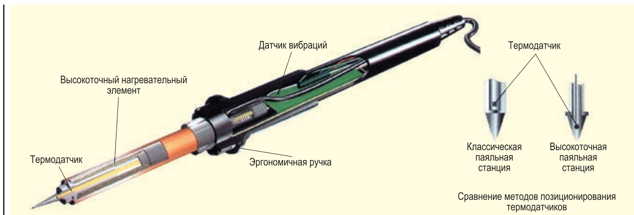
Рисунок 4 Конструкция паяльника станций серии 203 и 204
