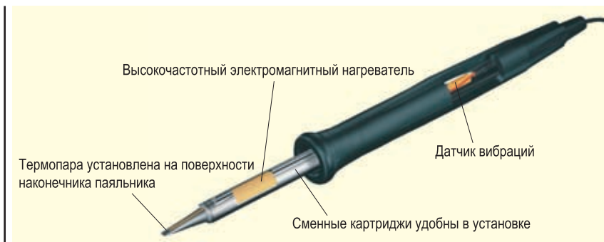
Рисунок 8 Конструкция паяльника станций серий 202х и 303х
